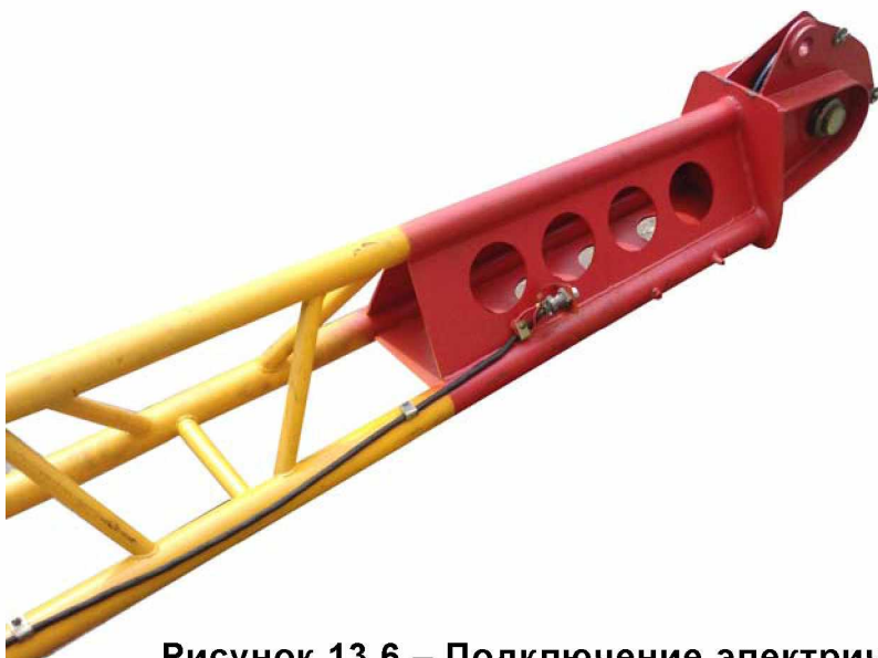
Рисунок 13.6 – Подключение электрического кабеля на гуське
